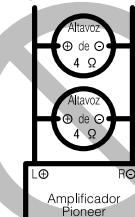
Modo de conexión en puente de 2 Ω
